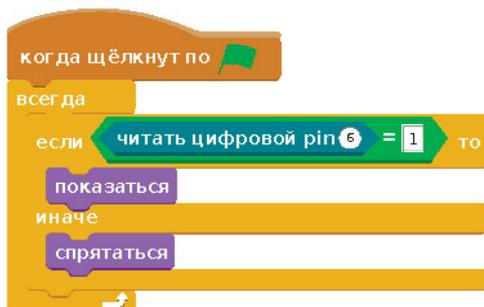
После запуска скрипта ты больше не видишь Панду в области анимации. Однако, при нажатии на кнопку она снова появится. Это связано с тем, что кнопка работает с цифровым сигналом, который имеет два значения (0 или 1): при нажатии сигнал равен 1, а при отпускании равен 0.
