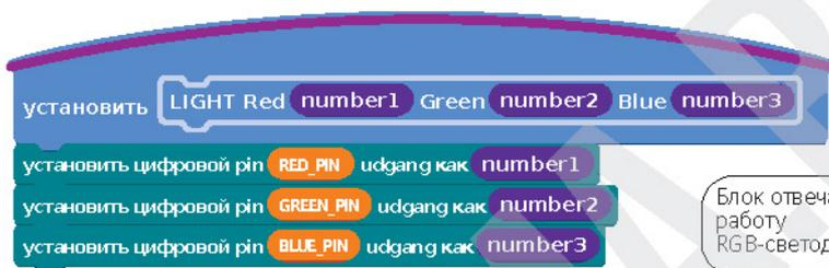
Блок отвечает за работу RGB-светодиода.
