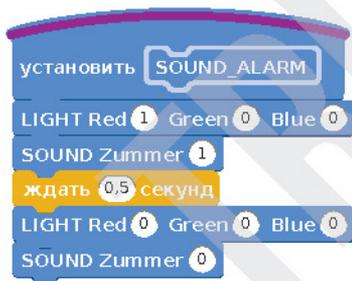
Блок отвечает за работу RGB-светодиода и Зуммера в случае, если громкость шума превысит заданное значение.
